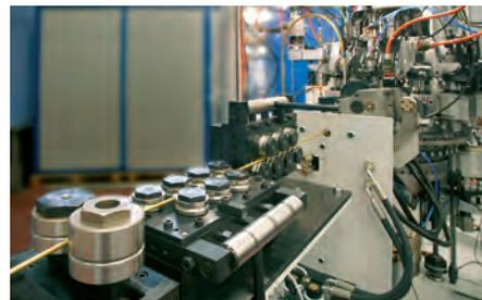
Zuführung direkt ab Draht
