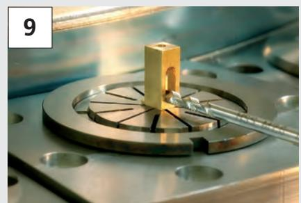
Bohren und gewindeschneiden seitlich
