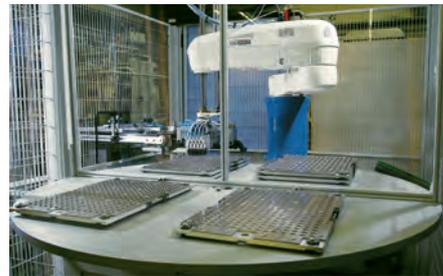
Zuführung über Paletten und Roboterarm
