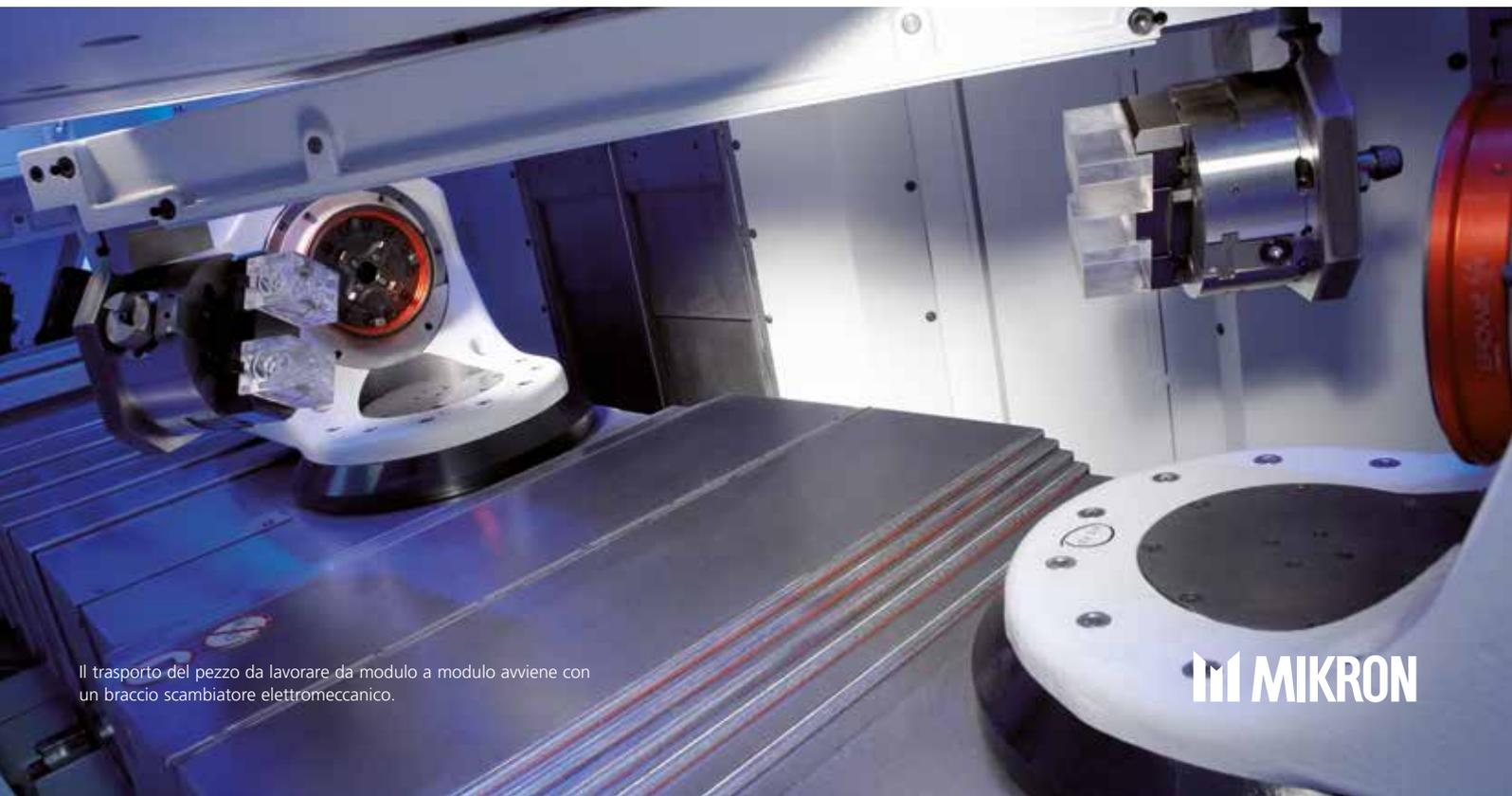
Il trasporto del pezzo da lavorare da modulo a modulo avviene con un braccio scambiatore elettromeccanico.
