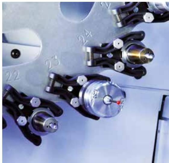
Il tastatore di misurazione viene scambiato come ogni utensile in 1 solo secondo.
