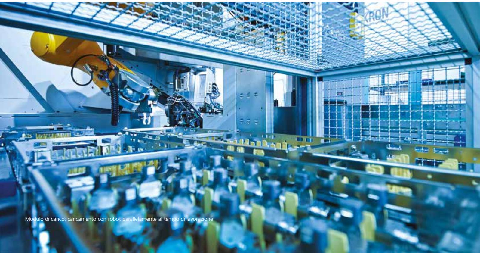
Modulo di carico: caricamento con robot parallelamente al tempo di lavorazione
