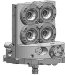
Serraggio quadruplo in un dispositivo
