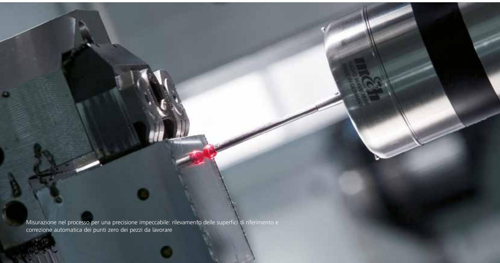
Misurazione nel processo per una precisione impeccabile: rilevamento delle superfici di riferimento e correzione automatica dei punti zero dei pezzi da lavorare
